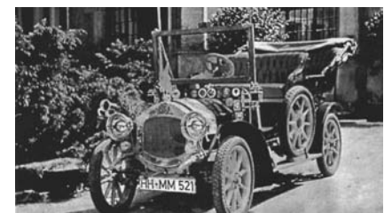
Kolibri - Baujahr 1908, 2 Zylinder, 436 ccm, 3,6 PS
